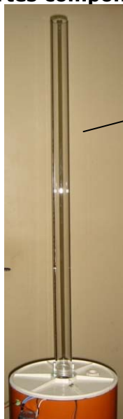
Figura 7: Partes componentes do reator fotocíclico: tampa e lâmpada.
