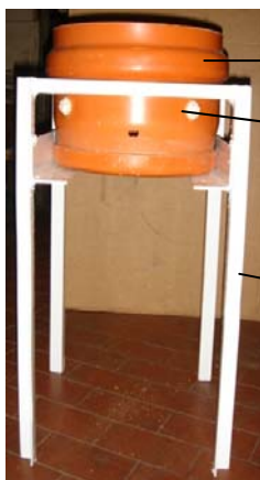
Figura 6: Partes componentes do reator fotocíclico: tampa e lâmpada.
