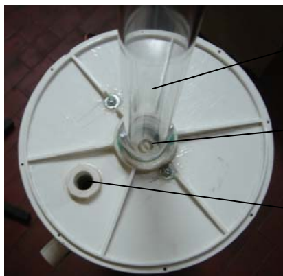
Figura 5: Partes componentes do reator fotocíclico: cap de fundo e suporte metálico.
