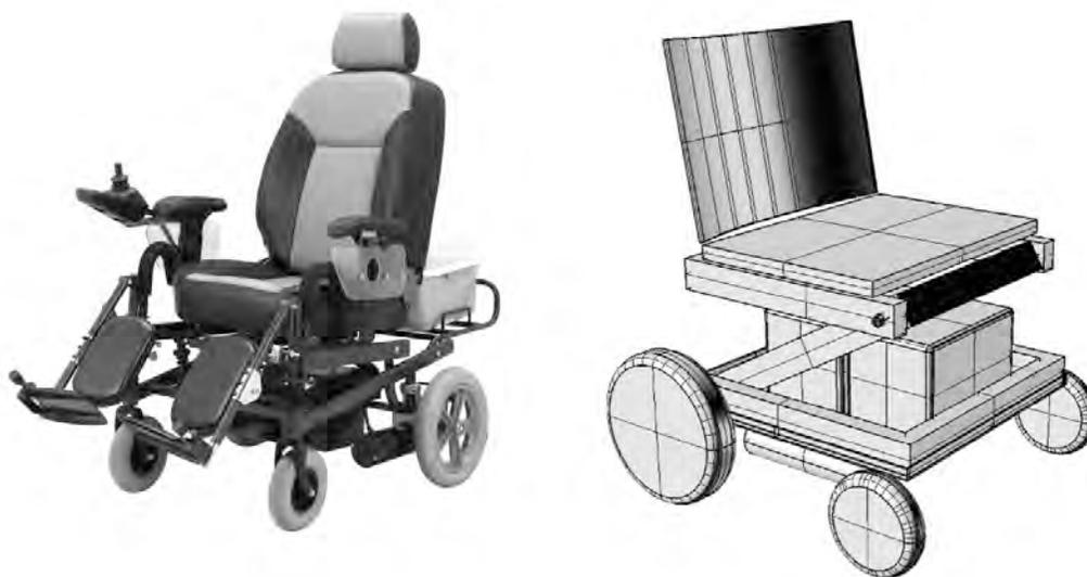
Fig.1: Comparação entre cadeira convencional, compactação clássica em "X", e a proposta do Projeto LLCC, compactação em "Z", à direita.
