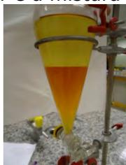
Figura 01: Funil de decantação com fases estabilizadas
