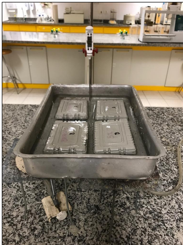
Figura 18 – Ensaio de expansão por umidade.
