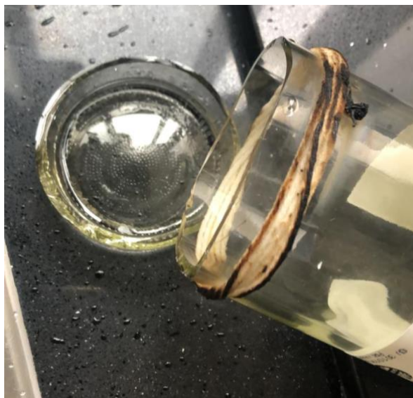
Figura 8: Corte caseiro da garrafa de vidro.
