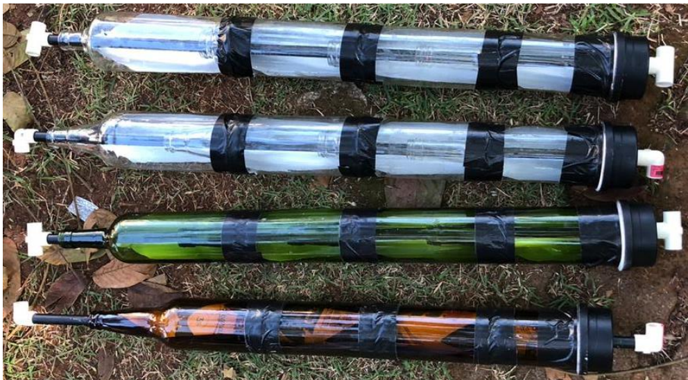
Figura 10: colunas de vidro do aquecedor solar.
