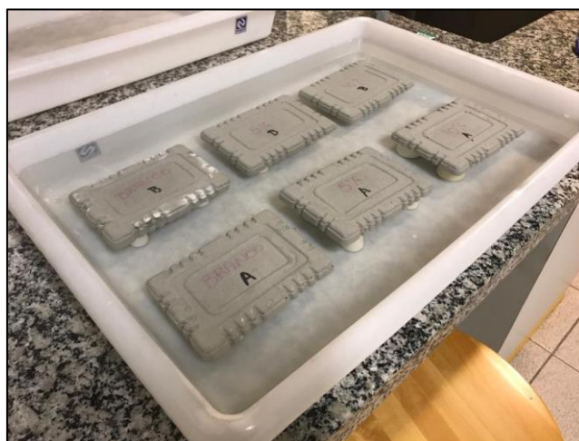
Figura 17 – Ensaio de absorção de água.
