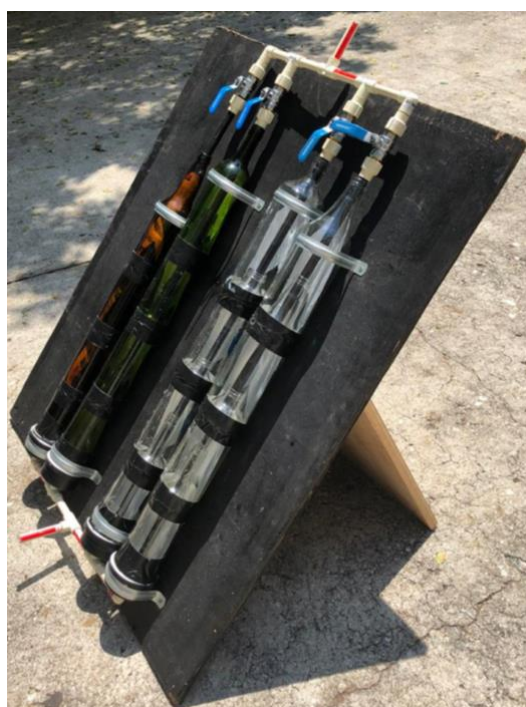
Figura 11: Aquecedor solar finalizado.
