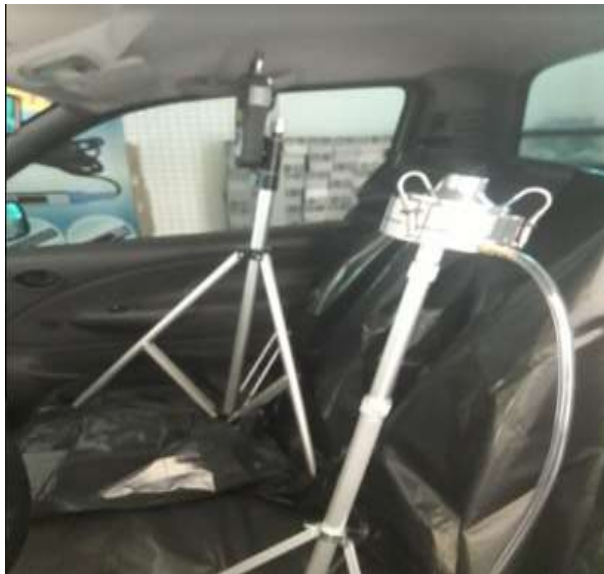
Fig. 2 – Equipamentos de amostragem do ar no interior do veículo
