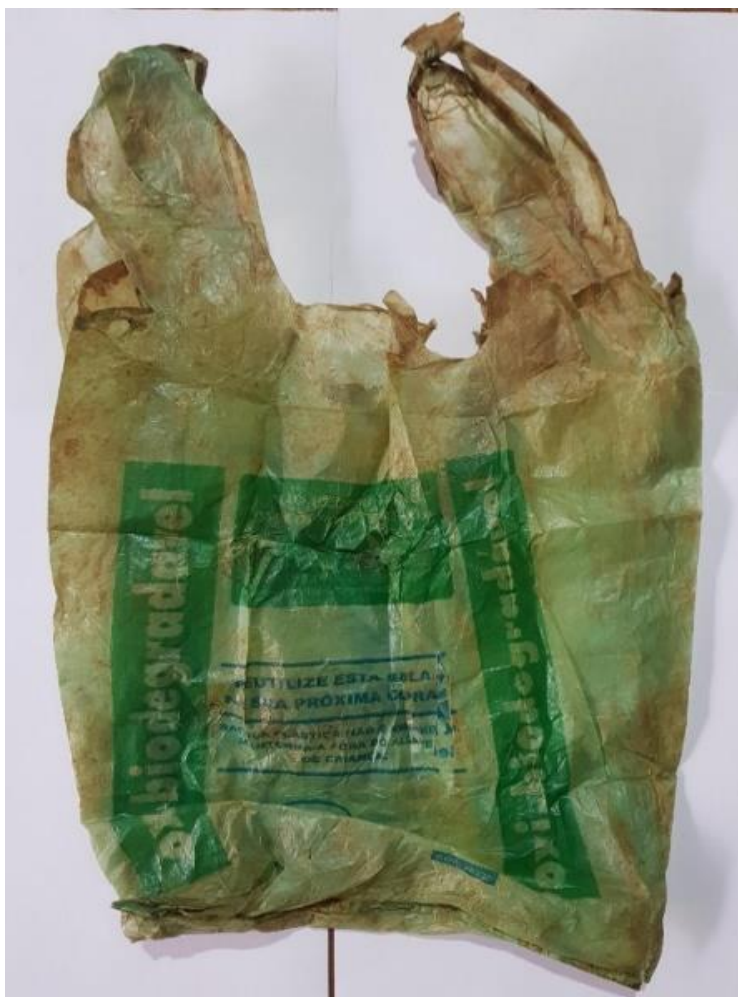
Figura 38: Aspecto visual da sacola oxibiodegradável após enterramento em solo por 36 meses.
