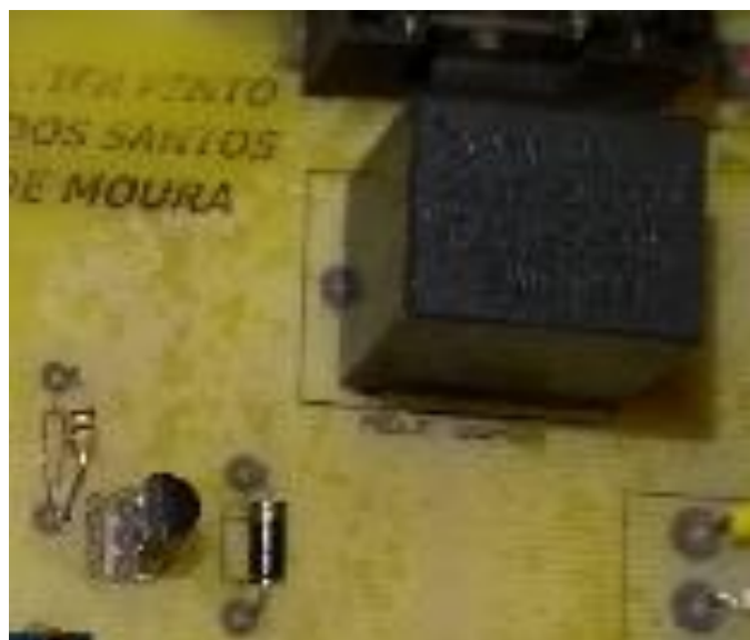
Figura 5 Driver de Acionamento
