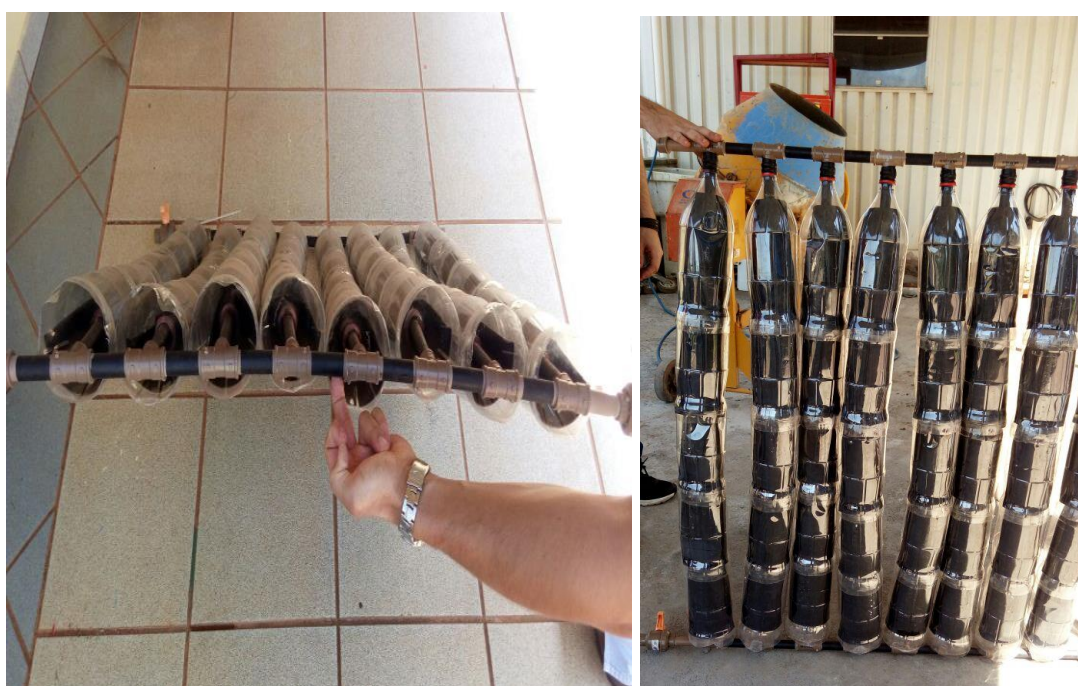
Figura 18: Placa com os canos de PVC deformados após 2 meses de uso.
