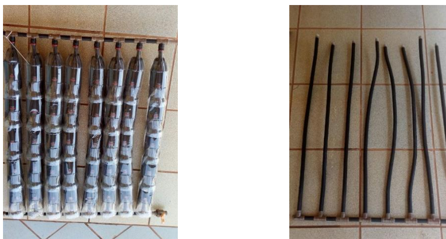
Figura 17: Flambagem dos canos de PVC.
