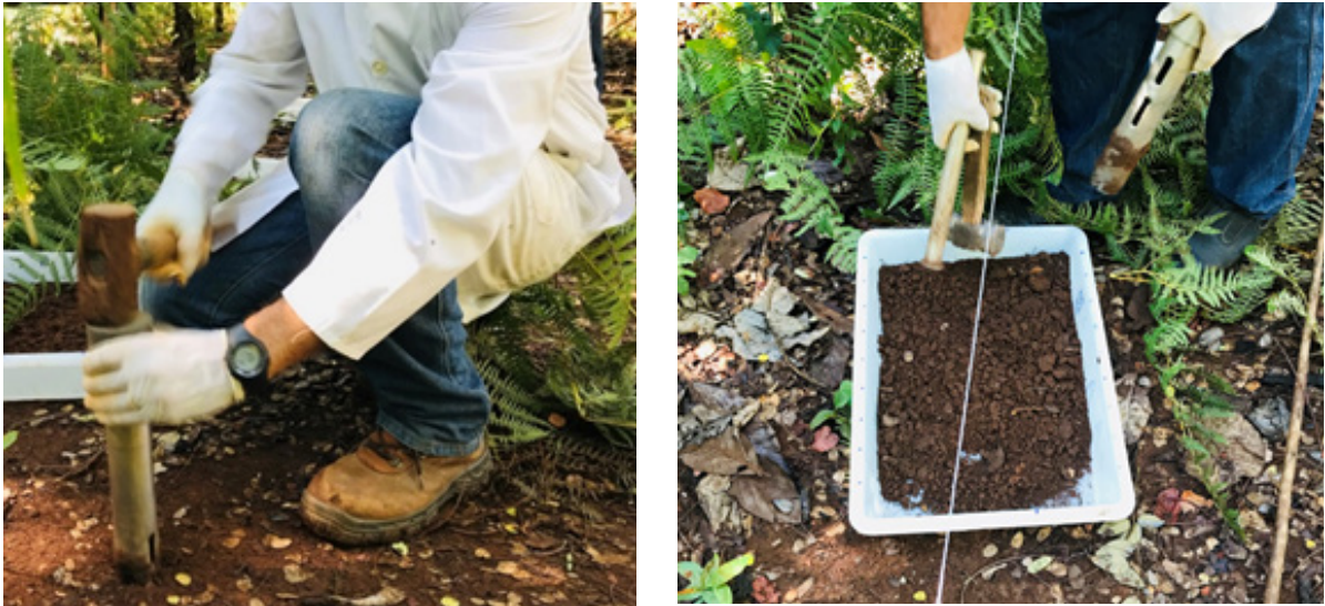
Figura 07: Cravação do amostrador e acondicionamento do solo em bandeja.
