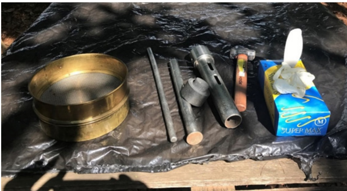
Figura 06: Peneira granulométrica, amostrador em aço inox, marreta para cravação, e luva de procedimento utilizadas durante os trabalhos de amostragem em campo.
