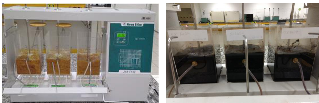
Figura 3 – Jar Test utilizado no processo de mercerização: bagaço de cana-de-açúcar (a) e coco (b).
