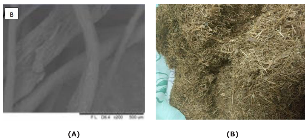
Figura 7 – Microscopia eletrônica de varredura das fibras de coco tratadas por mercerização - 7% NaOH (a) e fibras de coco secas (b).
