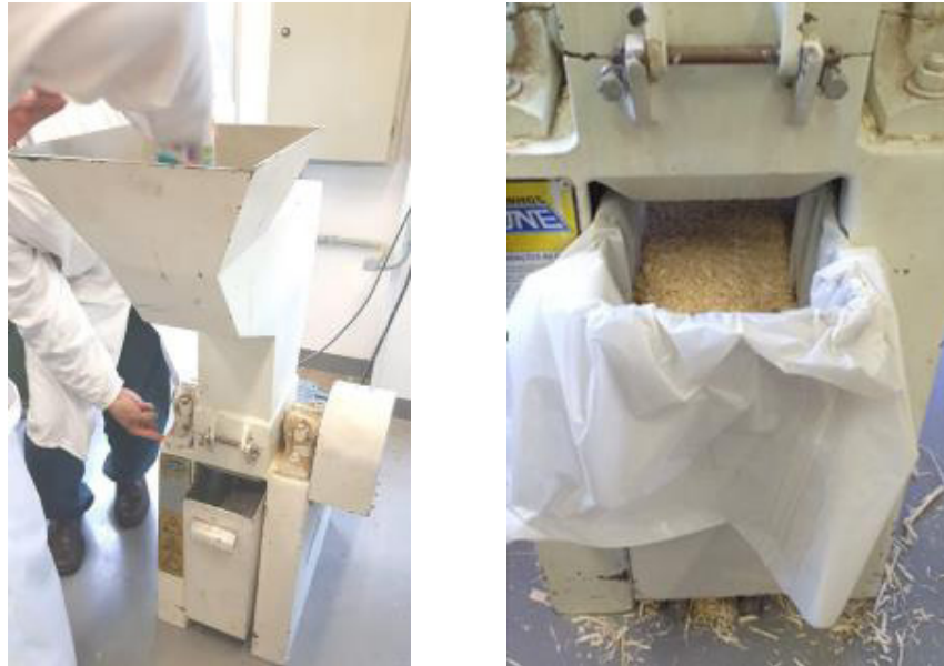
Figura 2 – Triturador utilizado para moagem do bagaço de cana-de-açúcar e do coco verde
