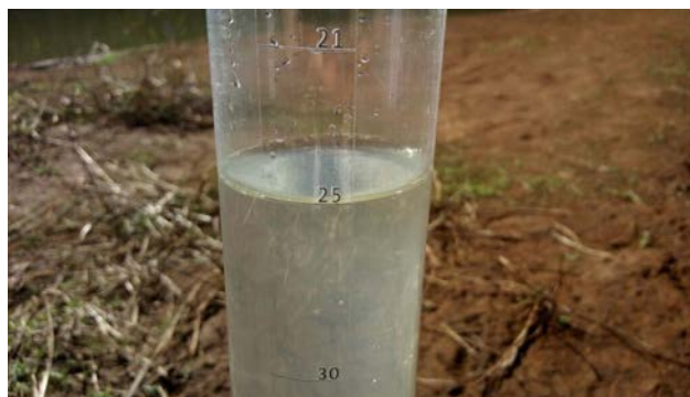
Figura 3 – Análise de turbidez utilizando o tubo Secchi.
