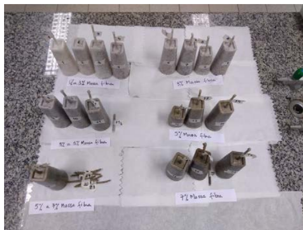
Figura 4 – Copos produzidos a base de bicomposto (polietileno + fibras naturais)
