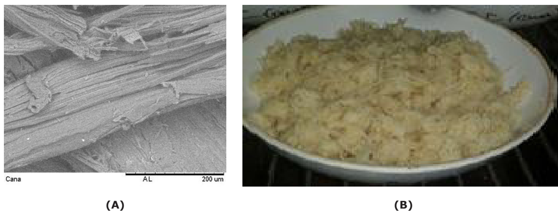
Figura 7 – Microscopia eletrônica de varredura das fibras de coco tratadas por mercerização - 7% NaOH (a) e fibras de coco secas (b).
