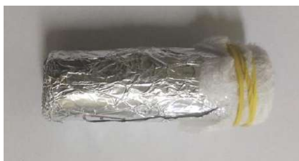
Figura 02. Tubo plástico utilizado como amostrador passivo de difusão gasosa para a quantificação de ozônio troposférico em Caçador e Fraiburgo/SC.
