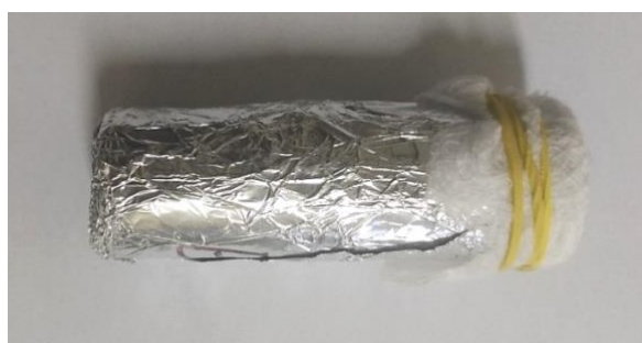
Figura 02. Tubo plástico utilizado como amostrador passivo de difusão gasosa para a quantificação de ozônio troposférico em Caçador e Fraiburgo/SC.
