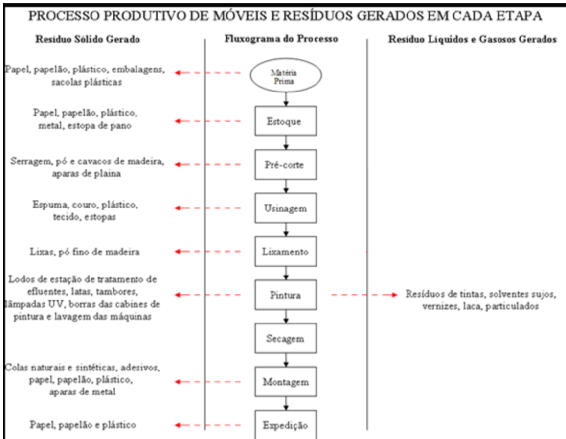
Figura 1: Fluxograma do processo produtivo de móveis e resíduos gerados em cada etapa.
