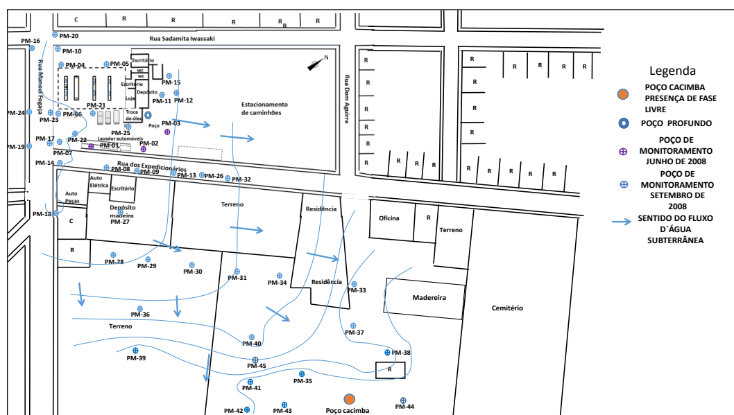
Figura 3 – Localização dos poços de monitoramento instalados pela Consultoria B e mapa potenciométrico do “aquífero livre”.
