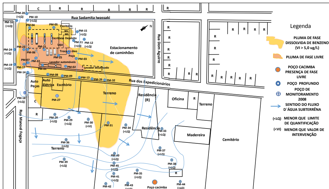
Figura 4 – Pluma de fase livre de diesel e de fase dissolvida de benzeno.
