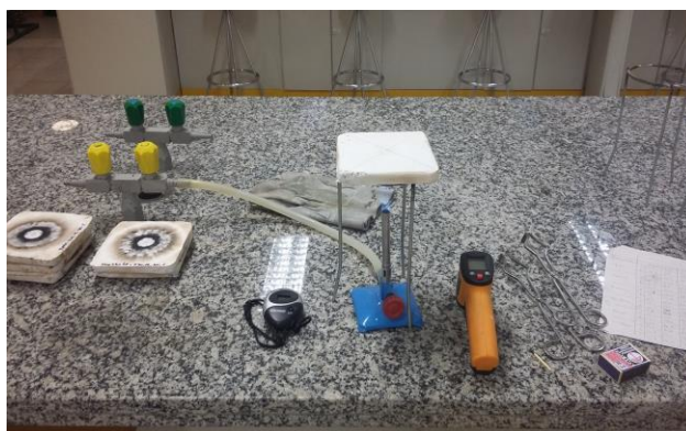
Figura 7. Ensaio para determinação quanto a resistência a chama
