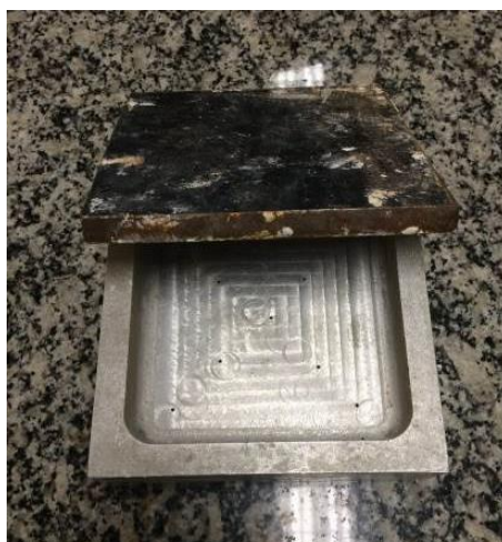
Figura 3. Matriz utilizada para confecção dos corpos de prova
