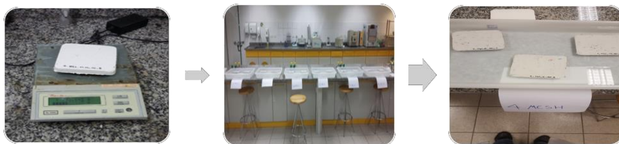
Figura 6. Processo para determinação da absorção de água dos corpos de prova
