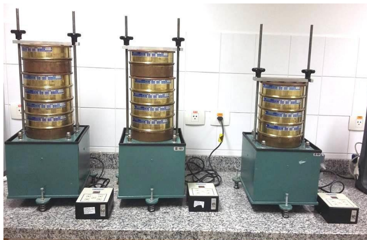
Figura 2. Vibradores de peneiras utilizadas para classificação granulométrica.
