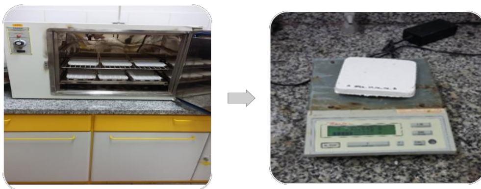
Figura 4. Processo para ensaio de determinação da massa dos corpos de prova
