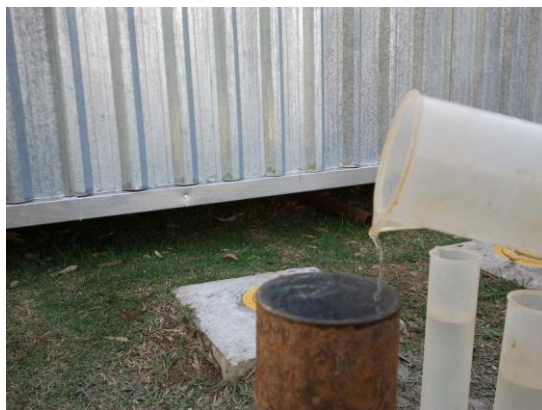
Figura 16: Execução do ensaio mantendo carga constante.
