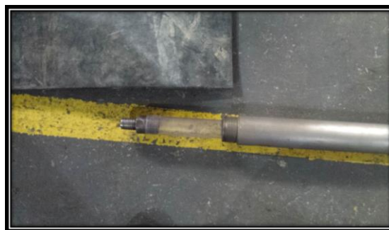
Figura 2. Parte superior do Amostrador Tubular Liner revestido pelo tubo externo do Dual Tube .
