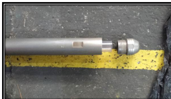
Figura 3. Parte inferior do Amostrador Tubular Liner revestido pelo tubo externo do Dual Tube .
