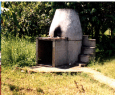
Figura 8 - Forno para queima de resíduos hospitalares
