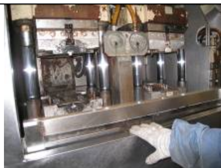
Figura 4 – Prensa aberta e limpa (sem restos de material).
