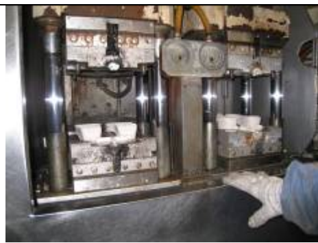
Figura 2 – Zona de prensagem aberta, com o solado injetado.
