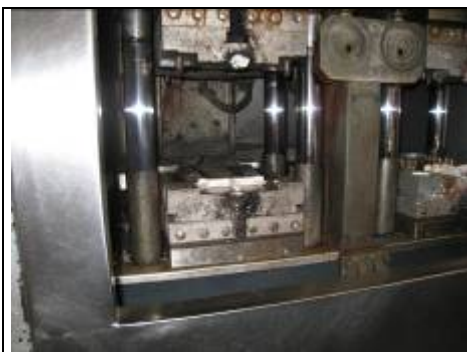
Figura 3 – Zona de prensagem aberta, sem o solado, mas com restos de material.
