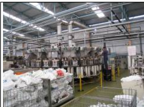
Figura 1 – Injetora com prensas em formato de carrossel.
