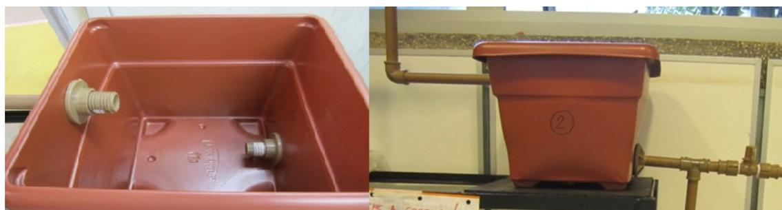
**Figura 04 – Localização da entrada e saída de fluxo nos tanques. Fonte: Autora, 2012.**
