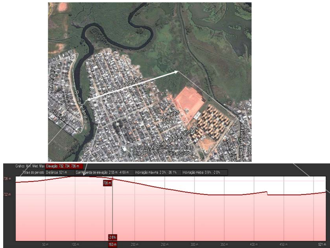
Figura 6. O perfil do terreno nas proximidades da Rua Canacatagê mostrando sua vulnerabilidade a enchentes no caso de elevação do nível das águas do Rio Tietê.
